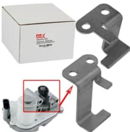
Grund für den Fehler - der Anschlagbegrenzer ist verschlissen. Beim Starten werden die Endpositionen angefahren. Je nach Laune kann es sein, dass der Stellmotor über das Ziel hinausschießt und dann das Steuergerät ein Fehler wirft. Der Fehler hat ein Verlernzähler. Nach einigen erfolgreichen Starts wird dieser Fehler wieder zurückgesetzt.
